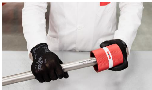
Figura 6 - Sbavatura del tubo
